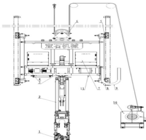
1. 钳体总成、2. 臂总成、3. 回转装置总成、4. 液压系统、5. 滑车总成、6. 滑轮总成、7. 电控系统、8. 限位总成、9. 拖链总成、10. 电动绞车
