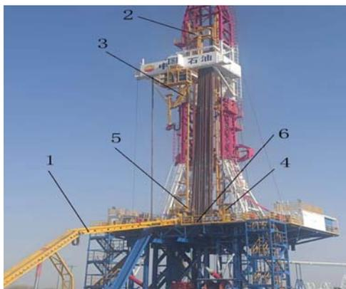
1-动力猫道,2-提管机械手,3-二层台排管机械手,4-铁钻工,5-扶管机械手,6-鼠洞管
