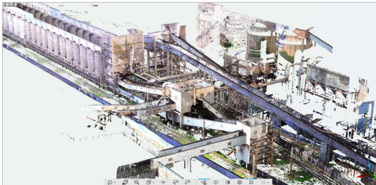
图2 成品仓区域三维点云配准成果
