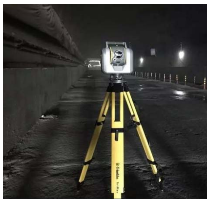
图1 SX10三维激光扫描仪工作照
